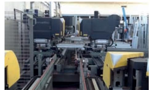
**Lavorazione cornice** con nuova Q-Matic (modulo di Integra 4H) e telaio saldato su 4 lati.
